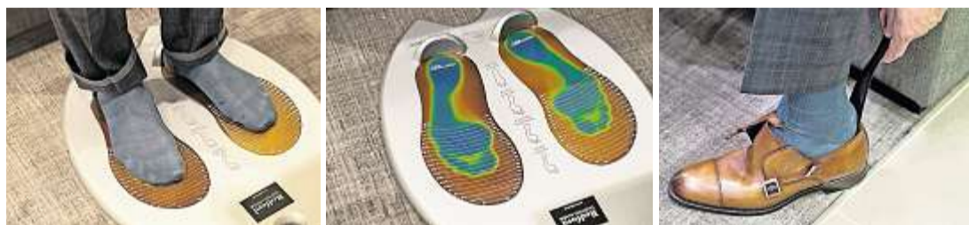
Die Füsse werden ausgemessen, damit auch die Druckverteilung auf der Fusssohle berücksichtigt werden kann.
